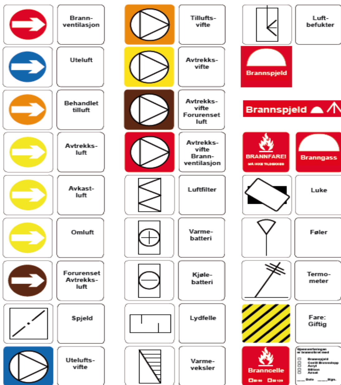
Figur 7-1 – Merking av ventilasjonsanlegg
