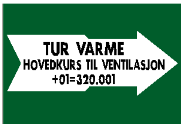
Figur 7-3 – Rørmerker med merkebånd som legges rundt røret med overlapp med individuell tekst i pil
